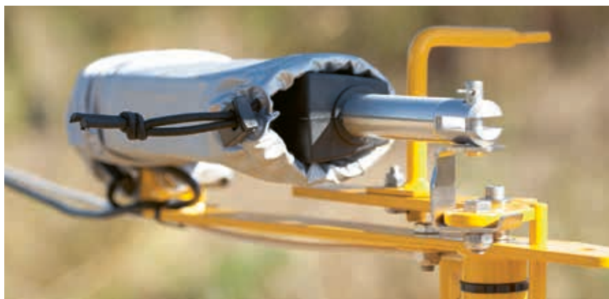
Elektrické ovládanie hraničného rozmetania pro CALIBRATOR ZURF / ICON
