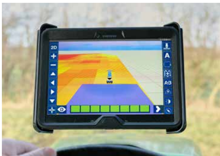
NAVI aplikácia pre riadenie rozmetadla pomocou GPS cez Android tablet (vyžaduje CALIBRATOR ZURF)
