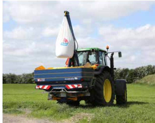
BXL 1300 unesie až 1300 kg a môže byť namontovaný na rozmetadlo s maximálnym objemom zásobníka až 3300 litrov.
