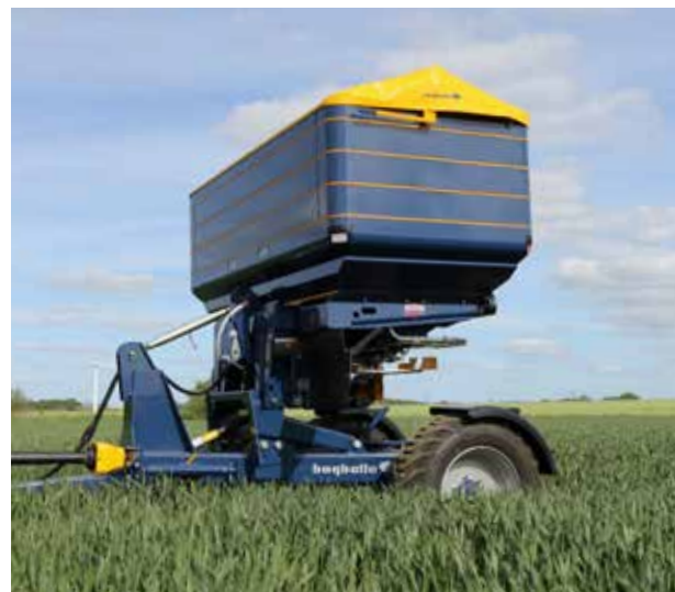
Rozmetadlo je možné z podvozku ľahko demontovať a použiť pre štandardné použitie pri neskorej aplikácii vo vysokom poraste.
